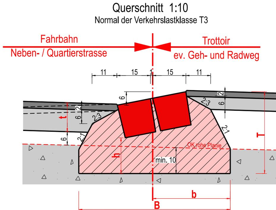
Der Fundamentbeton entlang von Randabschlüssen ist zwingend vorgängig dem Belageinbau zu reinigen und mit Bitumenemulsion Typ HC anzustreichen. NPK 223.424.221
