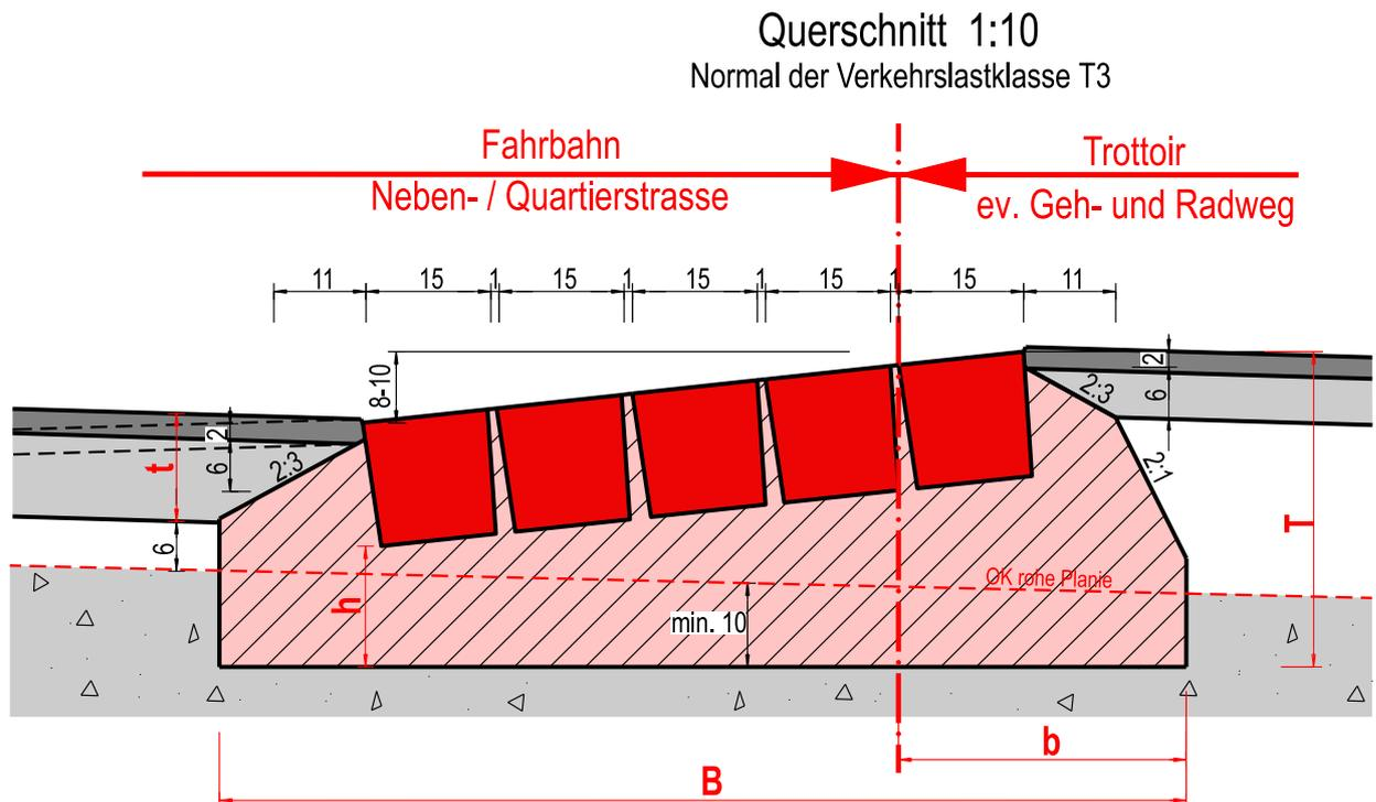
Der Fundamentbeton entlang von Randabschlüssen ist zwingend vorgängig dem Belageinbau zu reinigen und mit Bitumenemulsion Typ HC anzustreichen. NPK 223,424,221
