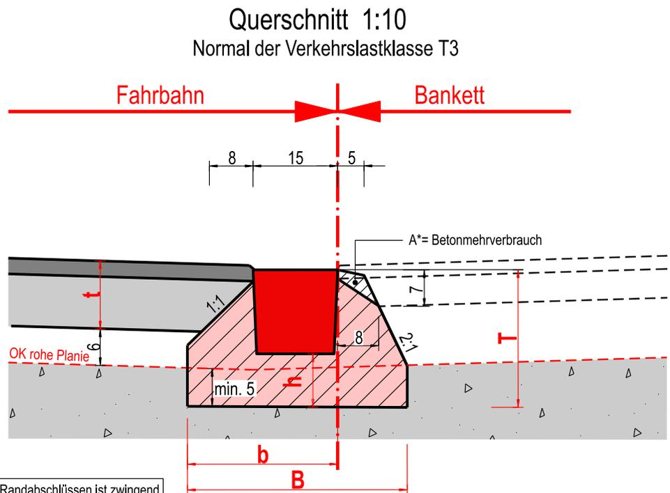
Der Fundamentbeton entlang von Randabschlüssen ist zwingend vorgängig dem Belagseinbau zu reinigen und mit Bitumenemulsion Typ HC anzustreichen. NPK 223.424.221
