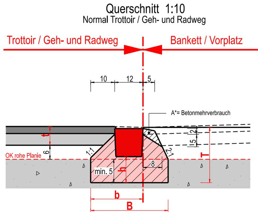
Der Fundamentbeton entlang von Randabschlüssen ist zwingend vorgängig dem Belagseinbau zu reinigen und mit Bitumenemulsion Typ HC anzustreichen. NPK 223.424.221
