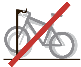
Lenkerhalter: Verbreitetes aber ungeeignetes Parkiersystem. Wird wenig benutzt und beschädigt Brems-, Licht- und Schaltkabel
